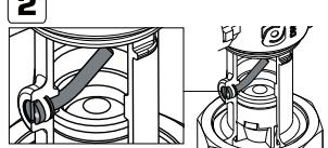
À la fin de l'étape de remplissage et de vidange, refitez la vis du clapet anti-retour à sa position de fonctionnement normale (voir image 2) et réglez le fonctionnement du circulateur sur le mode recommandé.
