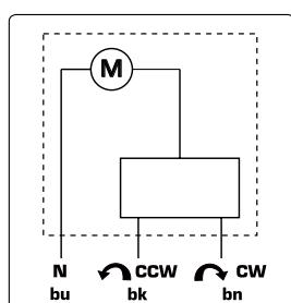
Привод 230 В пер. тока необходимо подключать через неподвижно смонтированный многополюсный разъем.
