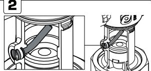
По завершении заполнения и удаления воздуха поверните винт на обратном клапане в нормальное рабочее положение (см. Рис. 2) и произведите настройку циркуляционного насоса.
