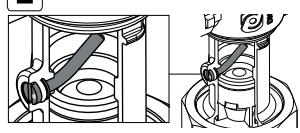
Po zakończeniu napełniania i odpowietrzania należy obrócić śrubę na zaworze zwrotnym ponownie do zwykłej pozycji roboczej, rys. 2 i ustawić tryb pracy pompy cyrkulacyjnej do zalecanej pozycji.
