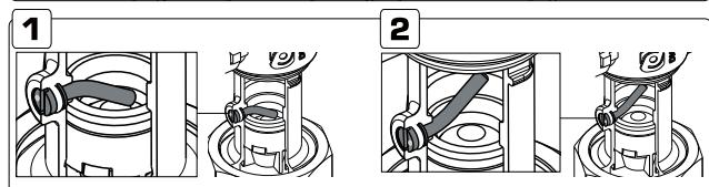
Ist der Befüll- und Entlüftungsvorgang abgeschlossen, stellen Sie die Schwerkraftbremse zurück in ihre Betriebsstellung (Bild 2).
