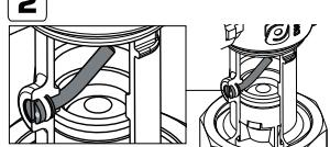
Dopo aver completato riempimento e sfato, portare di nuovo la valvola di ritegno alla posizione normale di funzionamento, immagine 2, e impostare il funzionamento della pompa di circolazione sulla posizione raccomandata.
