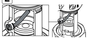
Efter en fullständig fyllning och avluftring, vrid skruven på backventilen tillbaka till dess normala driftläge, bild 2 och ställ in cirkulationspumpens drift till rekommenderat läge.
