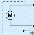
Циркуляционный насос подключается через стационарный многополюсный прерыватель.
