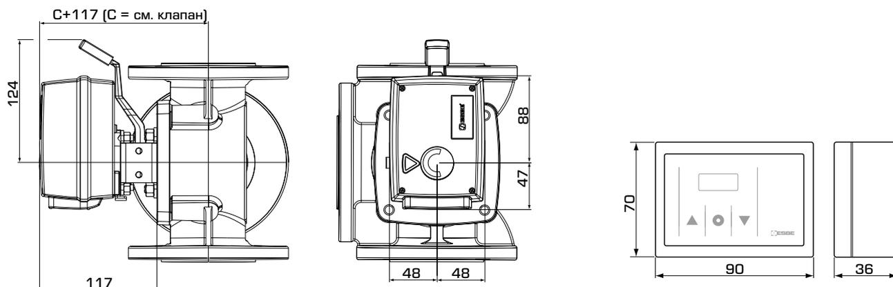
Установочные размеры для приводов серии CRC120 со смешивательными клапанами ESBE серий MG, G, F, T/TM, H/HG и BV
